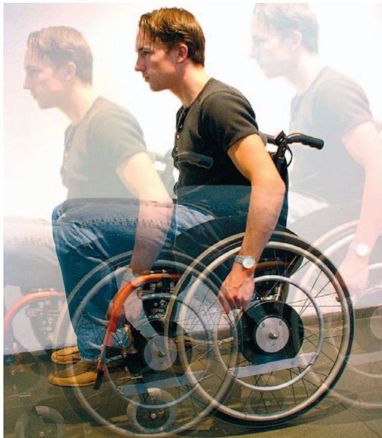
Wie een rolstoel als snelheidsmonster wil gebruiken, houdt gewoon de rest van de wereld voor de gek (door stiekem een elektromotor te gebruiken, zie binnenin de binnenste hoepel). [Foto: 3T/Indes]
